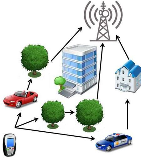
Figura 2.2: Enlace de comunicación entre un dispositivo móvil y una estación base con diversos obstáculos que impiden la línea de vista, escenario propio para un canal Rayleigh.
