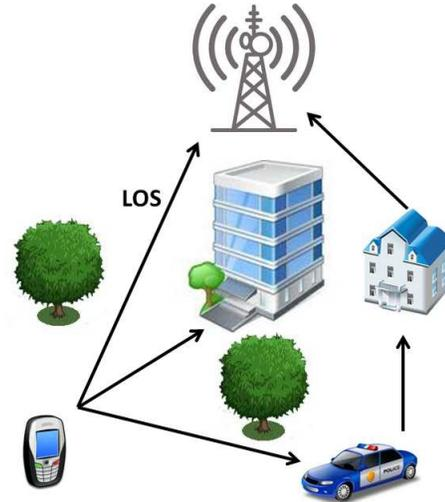
Figura 2.3: Enlace de comunicación entre un dispositivo móvil y una estación base con diversos obstáculos en donde se presenta una línea de vista, escenario propio para un canal Rician.
