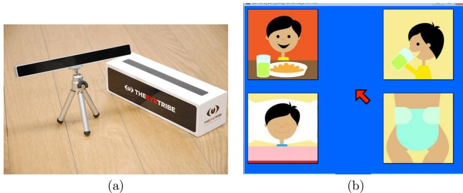
Figura 1: (a) Dispositivo EyeTribe para rastreo de movimientos oculares. (b) Ejemplo de interface para comunicación de personas discapacitadas.
