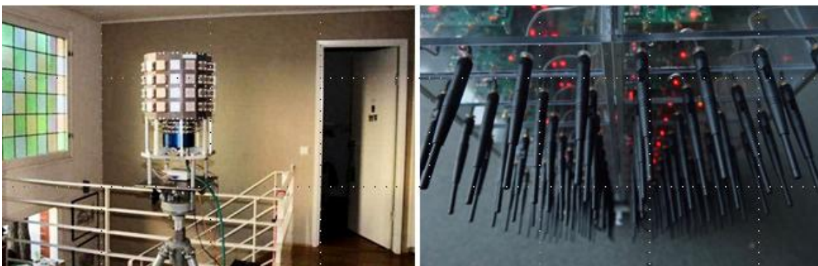
Figura 1. Ejemplos de modelos físicos de plataformas experimentales M-MIMO. Izq. con antenas de microcinta, der. con antenas omnidireccionales.
