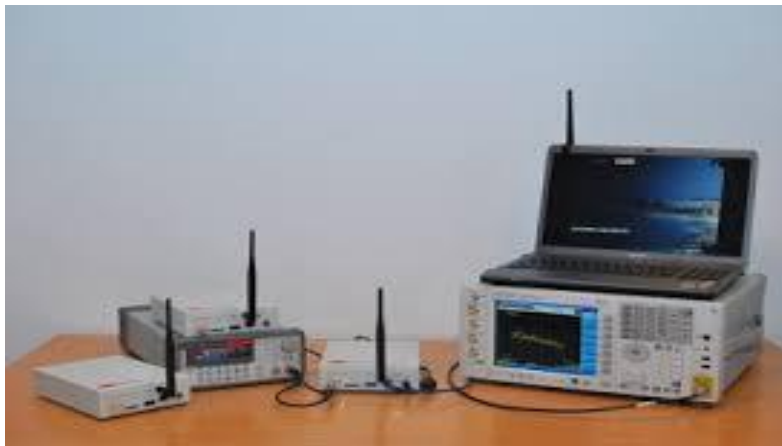
Figura 1. Emulación de terminal de radio cognitivo para llevar a cabo percepción de espectro usando Simulink (o GNU Radio) y USRP.
