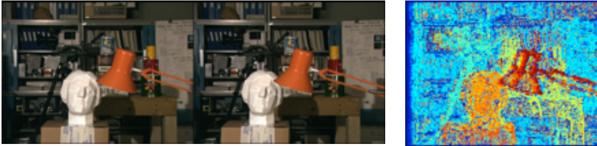
Fig. 2. A la izquierda, imagen estereoscópica tomada de la base de datos de Tsukuba. A la derecha, imagen de disparidad obtenida mediante block matching directo (sin preprocesamiento ni regularización) usando la métrica CENSUS en ventanas de 5x5 píxeles.
