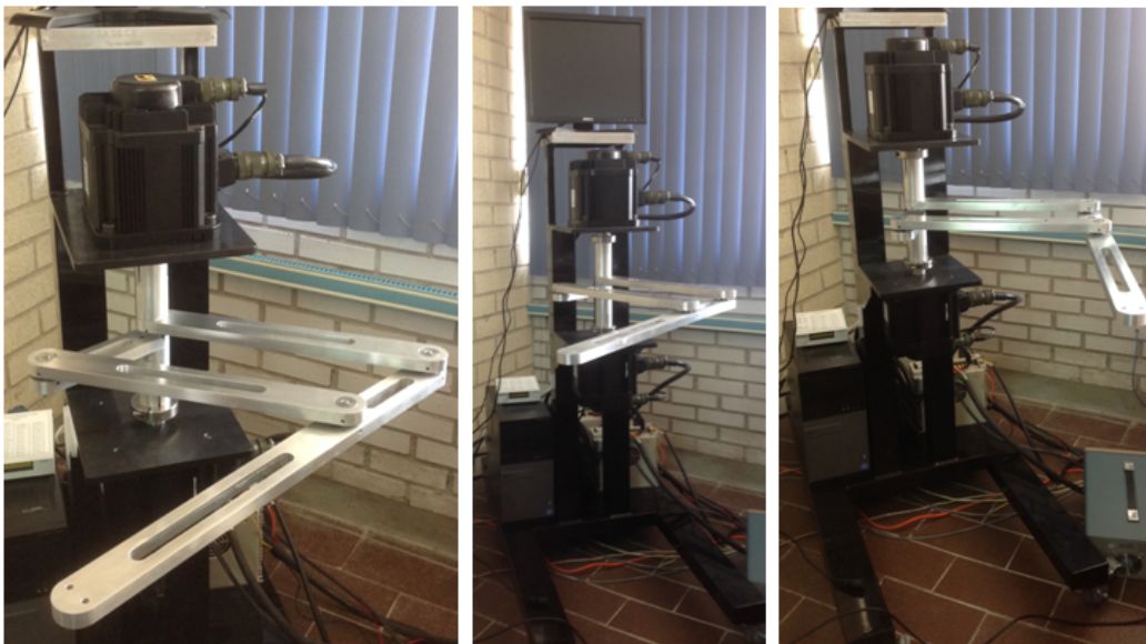
Figura 1: Sistema robótico de dos grados de libertad desarrollado en la Facultad de Ciencias, UASLP.
