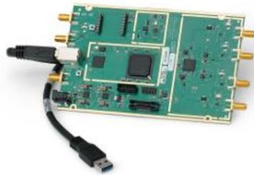
Figura 2. Tarjeta SDR USRP B210 para sistemas MIMO
