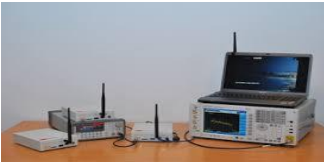
Figura 1. Ejemplo de sistema de comunicación inalámbrica con SDR
