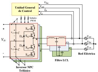
Figura 1. Convertidor de Diodo Enclavado con filtro LCL con conexión a la red eléctrica.
