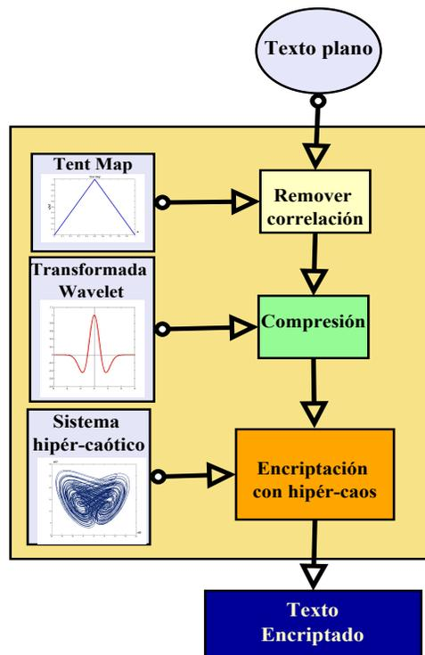
Figure 1: Diagrama a bloques que ilustra el sistema de compresión y encriptación de información.
