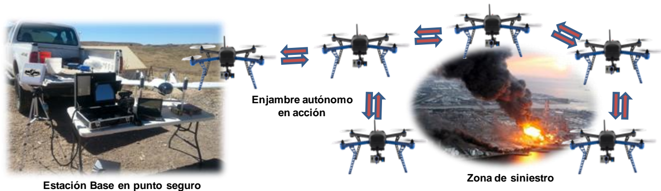
Figura 1. Al ocurrir un siniestro, los mUAVs entran al recinto con una ruta preestablecida acorde a los procedimientos de seguridad civil, se organizan entre sí y comienzan a enviar información valiosa a los cuerpos de rescate mediante sus bloques de sensores y comunicaciones.
